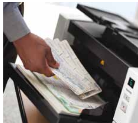
Il sistema di gestione della carta SurePath effettua regolazioni dinamiche a fronte dell'inserimento di fogli di dimensioni e spessori diversi.
